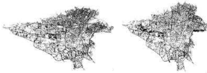
شکل (۵): استخراج راه‌های شهر تهران با استفاده از روش ماشین بردار پشتیبان (شکل چپ) و شبکه عصبی (شکل راست)
